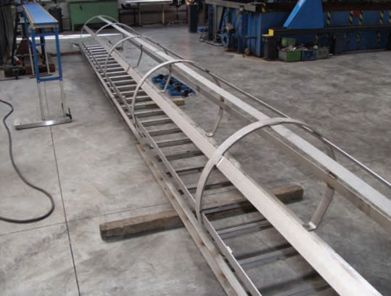
Leiterelement mit Absturzsicherung
