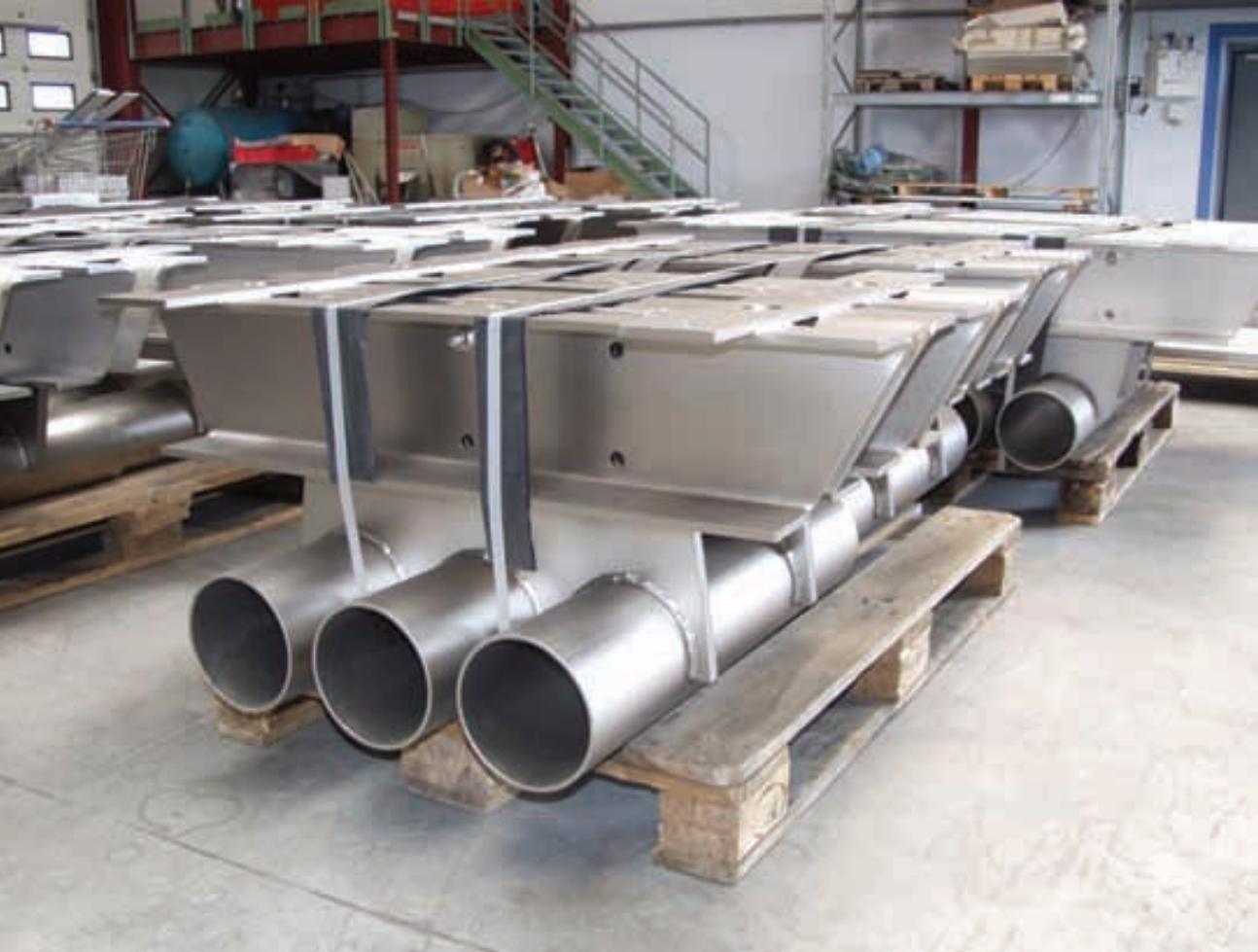
Schwere Schweißkonstruktionen, gestrahlt
